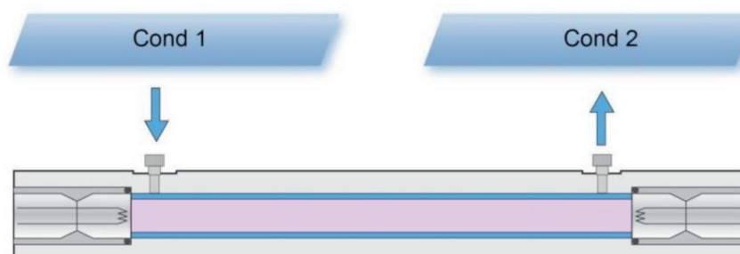
Fig. 3 - Sezione di un reattore UV
