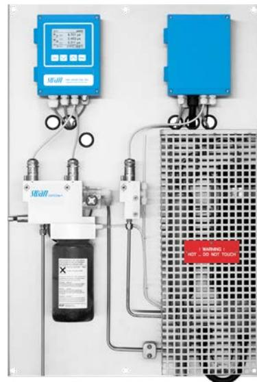
Drei-Kanal: Spezifische, Säure- und entgaste Säureleitfähigkeit
